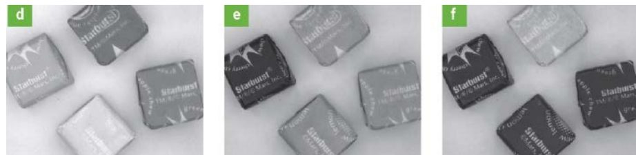
Unterschiedliche Lichtfarben erzeugen unterschiedliche Kontraste im Kamerabild: Szene für das menschliche Auge (a), Ergebnisbilder bei Einsatz einer Monochrom-Kamera und weißem Licht (b), rotem Licht (c), rotem und grünem Licht (d), grünem Licht (e) und rotem und blauem Licht (f).
