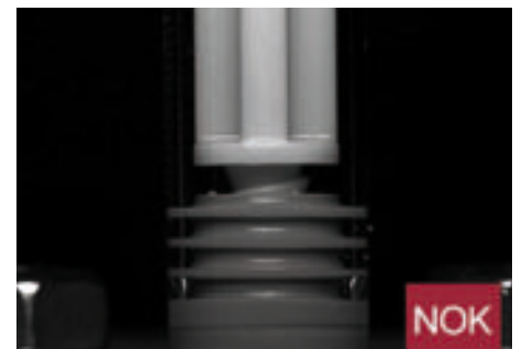
Die Einschraubtiefe der Kolbenstange in den Kolbenstopfen ist ein wichtiges Kriterium von Spritzen.
