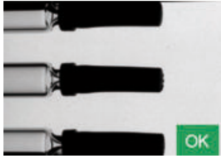
Die Prüfung der korrekten Position des Spritzenaufsatzes ist eine wesentliche Aufgabe bei der Produktion von Spritzen.
