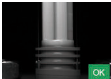
Die Einschraubtiefe der Kolbenstange in den Kolbenstopfen ist ein wichtiges Kriterium von Spritzen.
