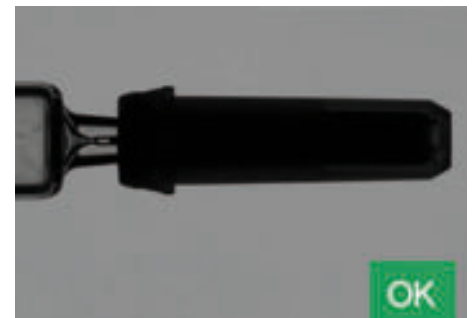
Die Gesamtlänge der Spritzen sowie die Klassifizierung der unterschiedlichen möglichen Formate sind weitere Aufgaben, die syringe.inspect-Systeme zuverlässig lösen.
