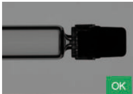
Die Gesamtlänge der Spritzen sowie die Klassifizierung der unterschiedlichen möglichen Formate sind weitere Aufgaben, die syringe.inspect-Systeme zuverlässig lösen.
