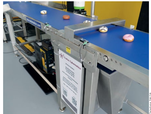
An der ersten Bildverarbeitungsstation reicht ein ganz schmaler Spalt zwischen zwei Transportbändern aus, um die Donuts mit einem 3D-Profilsensor der Z-Trak2-Serie von Teledyne Dalsa auf Fehler an der Unterseite zu überprüfen.
