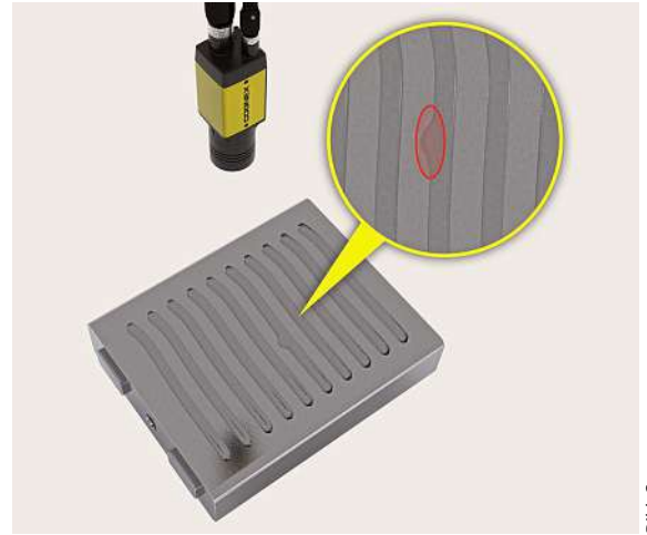
Bild 3: Bei der Untersuchung von Wärmeleitmaterial auf nicht vorhersehbare Fehler hat Deep Learning-basierte Bildverarbeitung deutliche Vorteile gegenüber der regelbasierten Bildverarbeitung.
