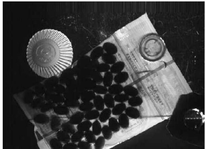
Bild 2: Mit der Kamera ist es möglich, beispielsweise die Qualität und Vollständigkeit der Außenseite einer Lebensmittelverpackung zu prüfen und gleichzeitig den Inhalt zu betrachten. Foto: JAI
