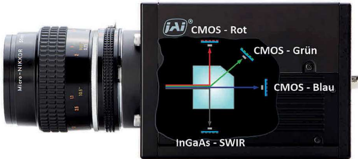
Bild 1: Eine neue Multi-Sensor-Zeilenkamera erfasst gleichzeitig rotes, grünes und blaues sichtbares Licht über drei separate CMOS-Sensoren sowie SWIR-Licht über einen vierten Sensor auf Basis der InGaAs-Technik. Foto: JAI
