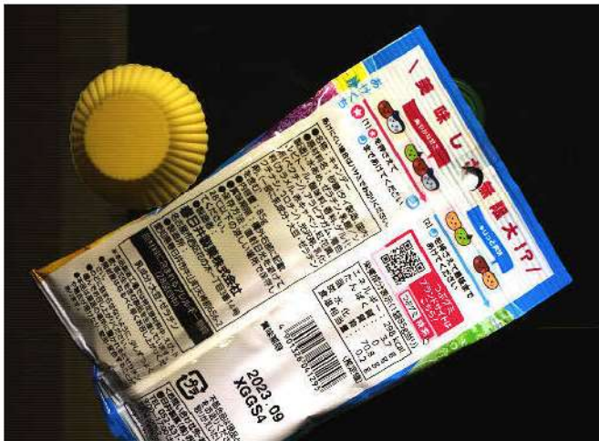
Bild 2: Mit der Kamera ist es möglich, beispielsweise die Qualität und Vollständigkeit der Außenseite einer Lebensmittelverpackung zu prüfen und gleichzeitig den Inhalt zu betrachten. Foto: JAI
