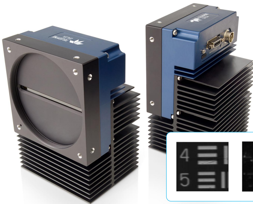
Bild 1 | Die Linea HS 16k Multifield-TDI-Kamera ermöglicht die zeitgleiche Aufnahme von bis zu drei Bildern unter verschiedenen Beleuchtungsbedingungen. Durch die unterschiedliche spektrale Empfindlichkeit der drei Sensor-Arrays ergeben sich unterschiedliche Bildergebnisse (links: mit Gegenlichtbeleuchtung, Mitte: Dunkelfeldaufnahme, rechts: Hellfeldbild).
