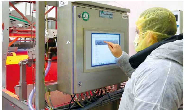
Über den Touchscreen des integrierten Industrie-PCs in einem IP65-Schutzgehäuse kann die Anlage bedient werden.
