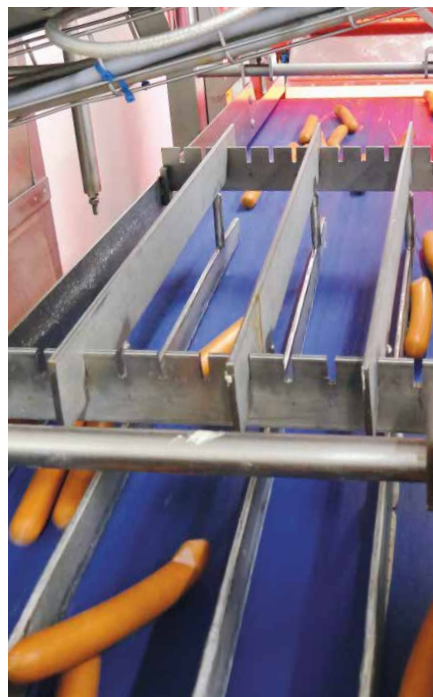
Je nach Produktgröße eingestellte Kaskaden richten die Würstchen grob längs zur Förderichtung aus.
