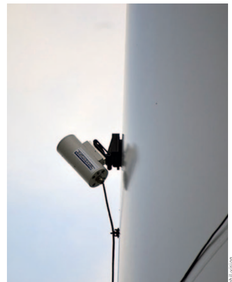
Sechs industrielle Farbkameras mit Auflösungen von 6 oder 20 Megapixel in wetterfesten Schutzgehäusen am Mast eines Windrads nehmen Bilder auf, um den Luftraum rund um das Windrad zu überwachen.
