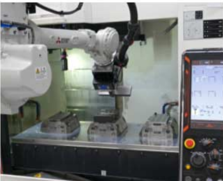
► Sechachs-Roboter des Typs RV-13FLM-D1-S15 oder RV-70FLM-D1-S15 mit 13 bzw. 70kg Tragkraft und 1388 bzw. 2050mm Reichweitenradius kommen für Handlingaufgaben zum Einsatz.
