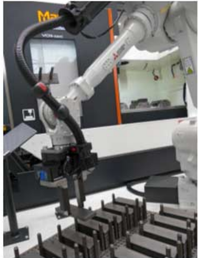
► Die Roboter entnehmen die Rohlinge nach festen Abläufen von vorbereiteten Paletten.
