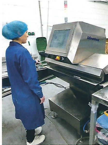
■ Abb. 2: Das Röntgeninspektionssystem Dylight von Minebea Intec beim Einsatz in der Fertigung von HCP Health Care Products Ltd.
