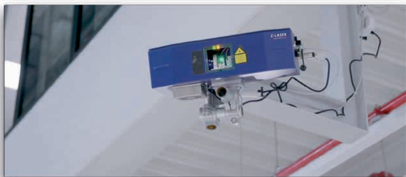
Je nach Lage der Schweißnaht projiziert einer von insgesamt sechs Laserprojektoren grüne Laserlinien auf die Karosserie und zeigt dem Mitarbeiter so die Sollposition mit Anfangs- und Endpunkt der Schweißnähte an.
