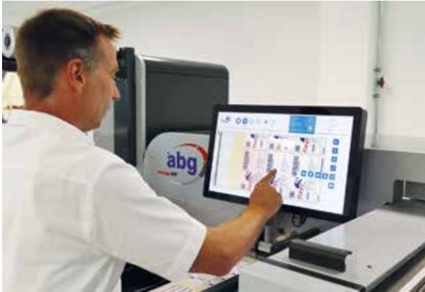
02 Die Fleye-Vision-Bedienoberfläche erlaubt eine schnelle automatische oder bei Bedarf manuelle Einrichtung neuer Labels
