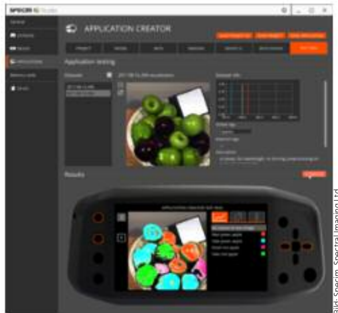
Bild 2 | Specim IQ Studio erlaubt die Verwaltung der aufgenommenen Bilder, sowie die Entwicklung von Applikationen ohne hyperspektrales Expertenwissen.
