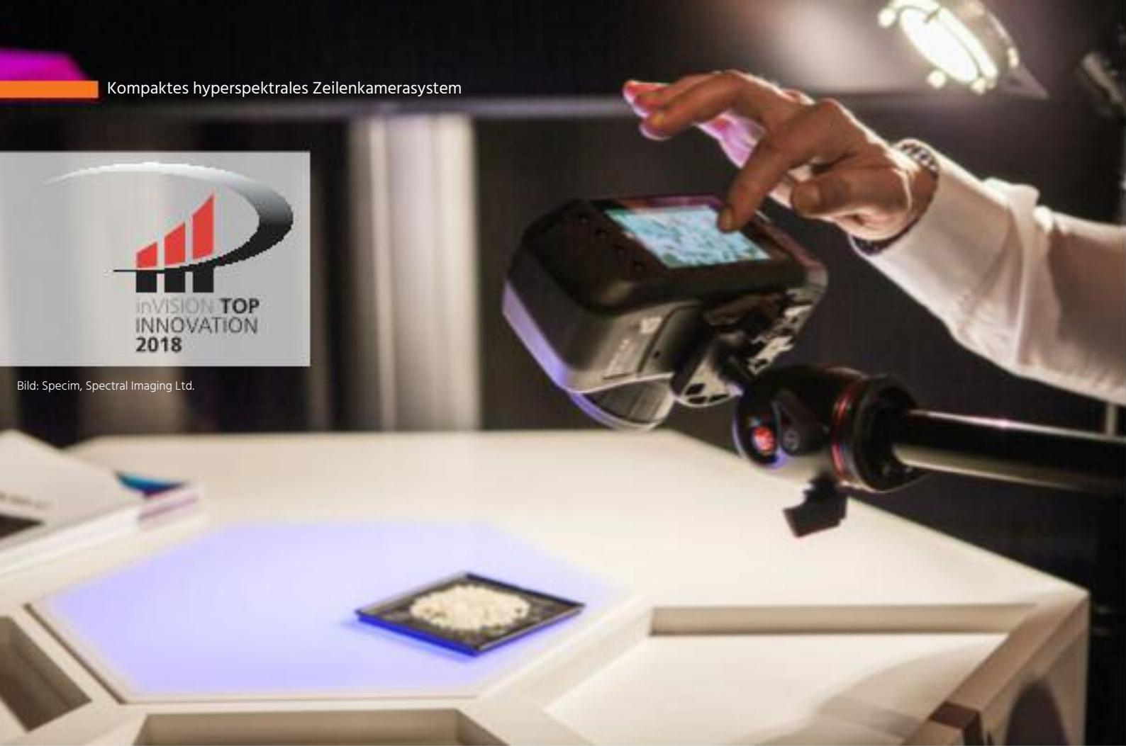
Bild 1 | Die Specim IQ erinnert in ihrer Form an Kompaktkameras aus dem Konsumerbereich, ist jedoch ein komplettes System zur hyperspektralen Bildverarbeitung.
